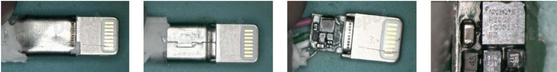
Em primeiro lugar, retiramos a tampa de plástico do conector com certificação MFi. Uma vez que a tampa é retirada, podemos ver o compartimento de metal, com o compartimento de metal removido, agora podemos ver os chips MFi.
